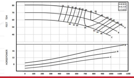
SL11H SINGLE STAGE 1770 RPM PERFORMANCE CURVE
