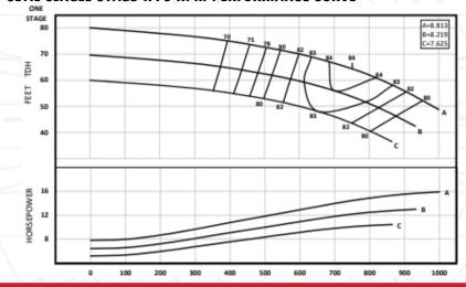
SL11M SINGLE STAGE 1770 RPM PERFORMANCE CURVE
